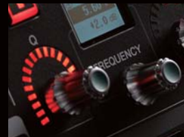
马蹄形环绕显示编码器
